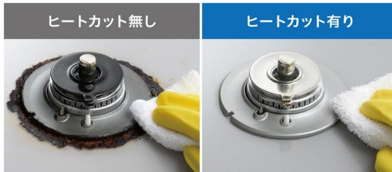
ヒートカット有無での加熱試験比較(いずれもガラストップ)
